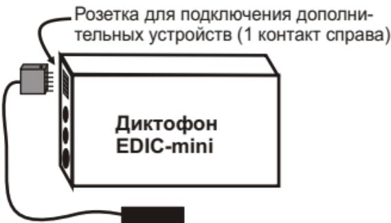
Рис.1 Подключение выносного микрофона к диктофону всех моделей, кроме А1, А4, А4М, А3М, А4М1, SM, SM-М
