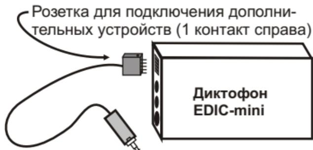
Рис.1 Подключение Переходного кабеля
