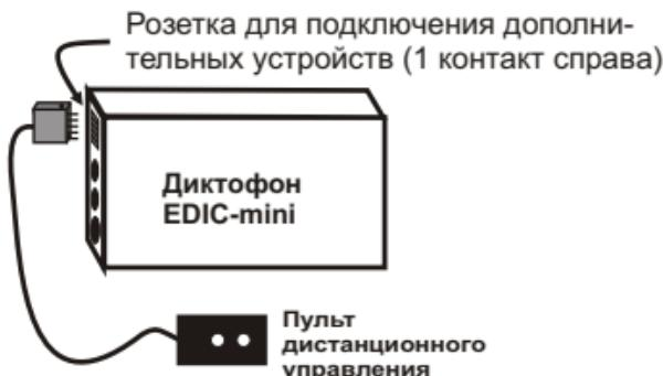
**Рис.2 Подключение пульта дистанционного управления к диктофону, кроме модели А1, А4, А4М, А3М, А4М1, SM, SM-M**
